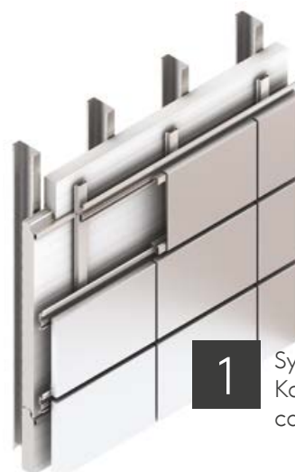
Système KarrierPanel® avec écran pare-pluie à métal à simple paroi
